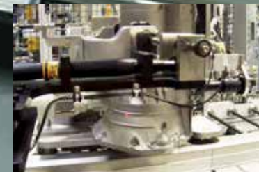
Kamera- und lasergestützte Objekt- und Oberflächenkontrolle bei der Motoren- und Getriebemontage.
