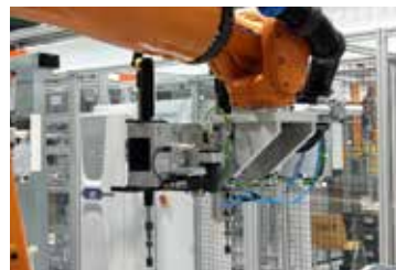
Robotic mit kameragestützter Objekt- und Stellplatzerkennung im Atomotivbereich.
