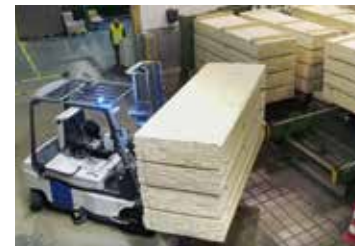
Autonome Beschickung von Transportanlagen mit Brettstapeln in der Holzindustrie.
