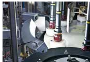
Kameragestützte Behälterausrichtung anhand unterschiedlichster Merkmale der Produkte in der Getränkeindustrie.
