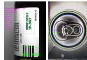
Labelkontrolle für Sitz-, Barcode und OCR Erkennung sowie Behälterkontrolle in allen Leistungsbereichen.
