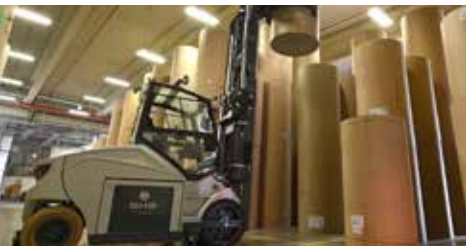
Autonome Lagerbeschickung von Papierrollen in der Wellpappenindustrie.
